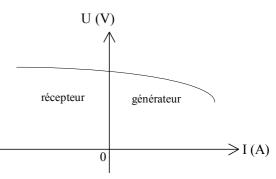
Un dipôle actif est dit **linéaire** si sa caractéristique est une **droite**. On peut alors déterminer l'équation de cette droite, sous la forme (écriture en convention générateur):
