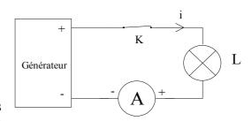
Si, pendant la durée t, N charges transportent une quantité d'électricité Q, on appelle intensité du courant électrique, noté I, la quantité d'électricité transportée par unité de temps:
