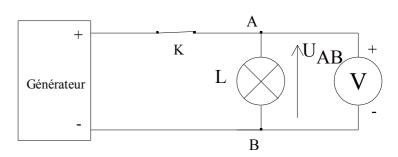
$V_A$  et  $V_B$  sont respectivement les **potentiels** des points A et B par rapport à un potentiel de **référence** (généralement la masse:  $V_M = 0V$ ).
