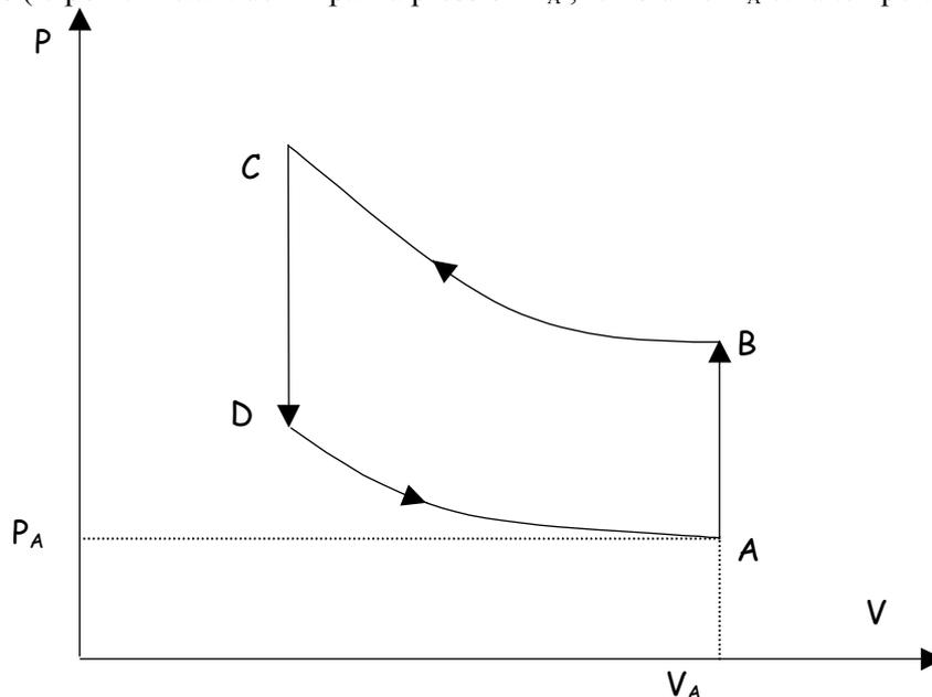
A B : chauffage isochore jusqu'à la température  $T_B$ .
