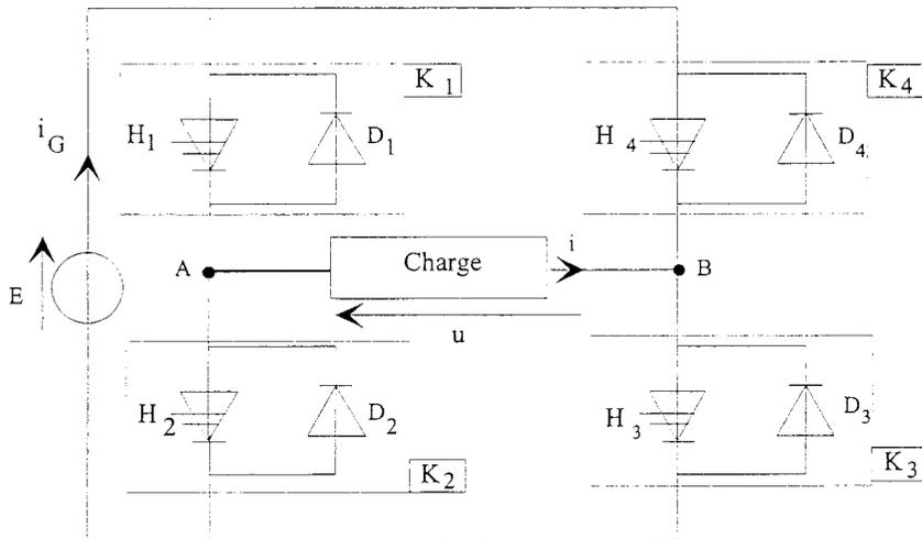
Les interrupteurs commandés et les diodes sont considérés parfaits. L'onduleur est alimenté par une source de tension continue E.
